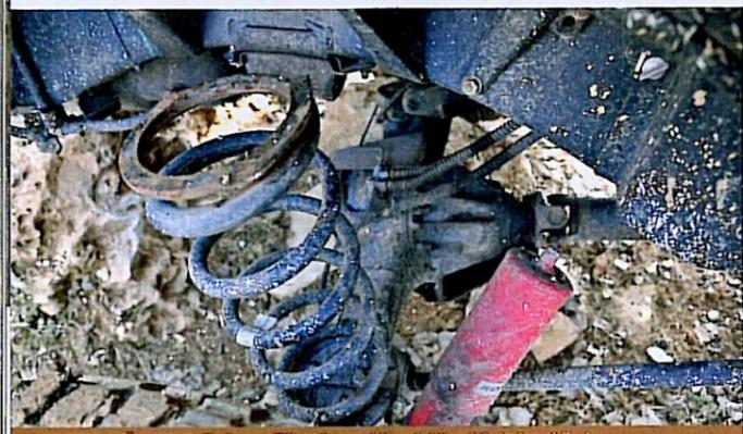
ABRISS-DÄMPFER: Zu kurze Dämpfer und Verzicht auf Achsfangbänder.
